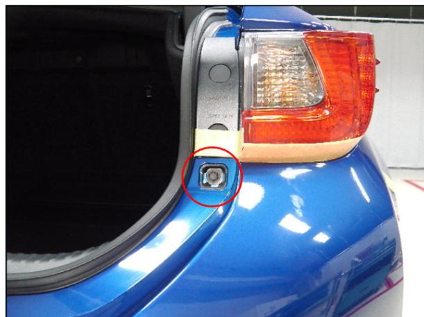
⑤ クリップリムーバを使用して、クリップ 6 個を取り外します。
