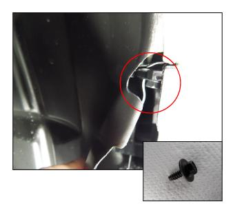
④ フロントアンダカバーNo.1 のスクリュ 2 本およびファスナ 2 個を取外します。
