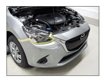
② フロントマッドガードのスクリュ3本およびファスナ3個を取外します。
