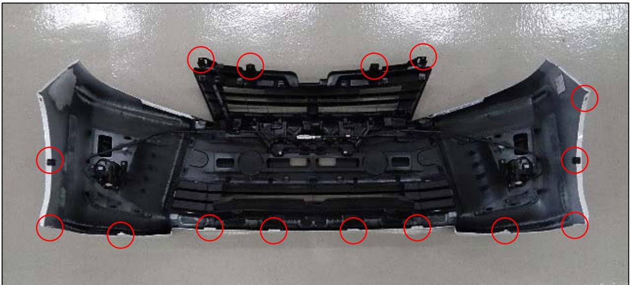
※ 使用工具： 10mm ボックスレンチ、マイナスドライバ、プラスドライバ、クリップリムーバ
