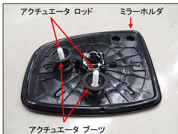
※ アクチュエータロッドとアクチュエータブーツがミラーホルダ側についてきた場合、アクチュエータ側に挿入し取付けます。
