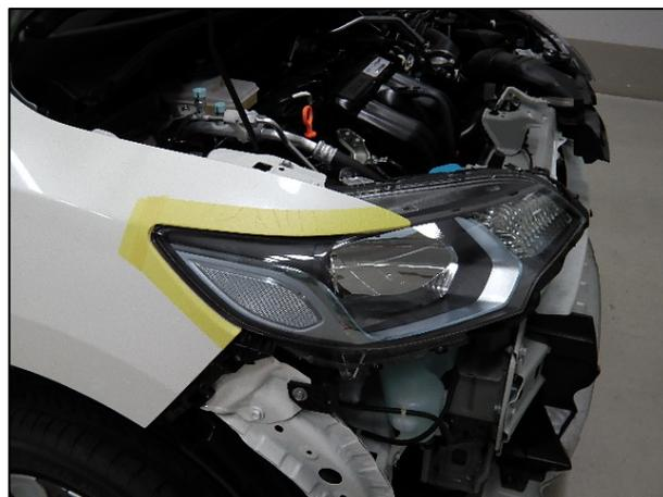
② ボルト4本を外し、ヘッドライト ASSY およびフロントバンパコーナアツパビームを取外します。
