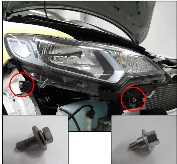
③ 各カプラの接続およびクリップ2ヶ所を外します。
