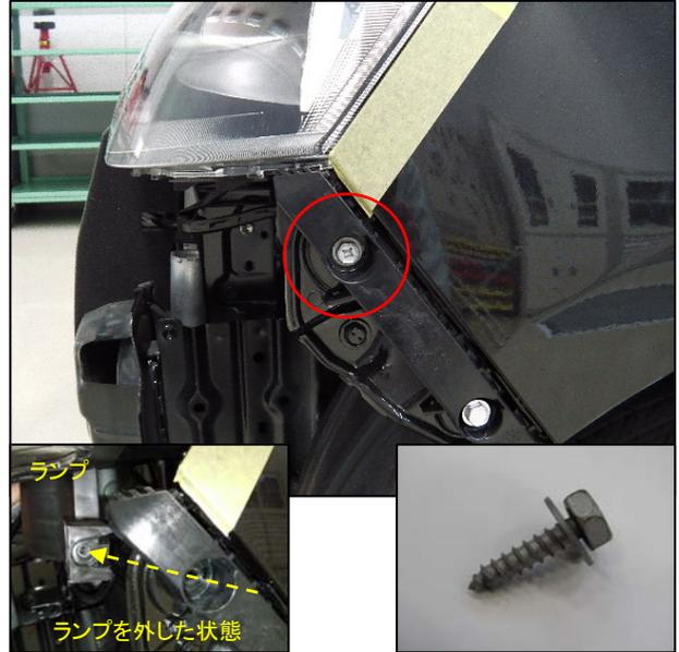
③ ヘッドランプを車両前方へ取り外し、各バルブのコネクタを取り外します。
