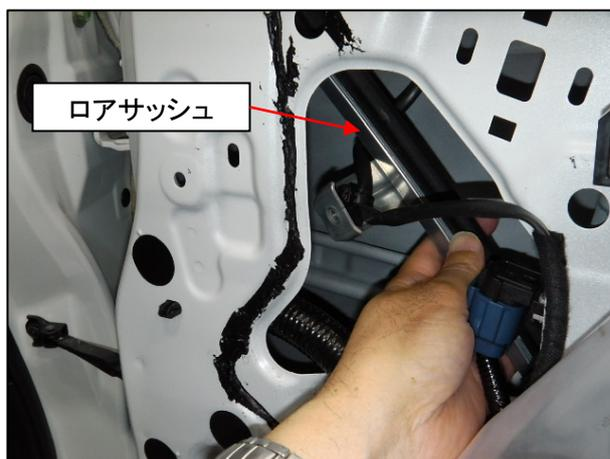
⑤ フロントドアアロアサッシュからドアミラーのハーネスクリップを外します。
