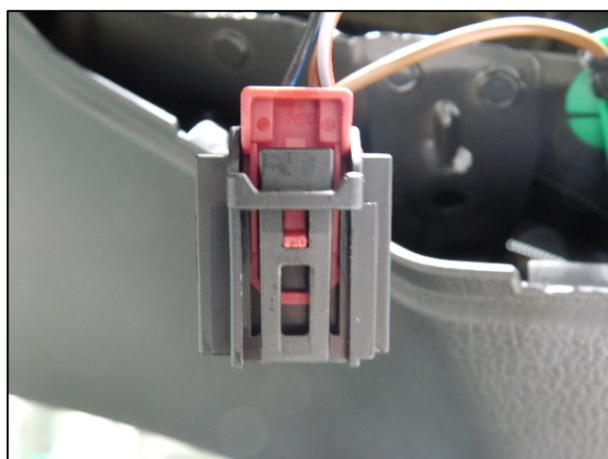
※ 取り付けは、取外しの逆でコネクタをさしロックをします。
