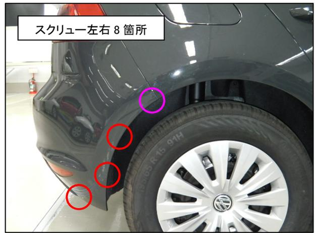
※ リヤバンパを固定しているのは、上部のツメ勘合部、左右上部のスクリー-および下部のクリップ 2箇所です。
