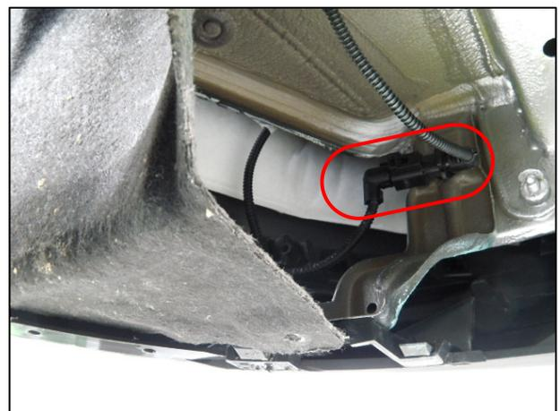
⑥ リヤバンパカバーのサイド部を手前に引き、ガイドピースのツメ勘合を外します。
