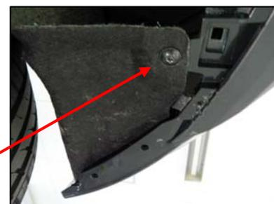
④ リヤバンパ下部、トルクスレンチを使用して、クリップ 2 個を取り外します。
