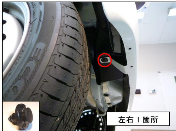
④ リヤバンパをリヤバンパサイドサポート部のツメ(片側 6 箇所)の下方から 1 箇所ずつ破損しないように取り外します。
