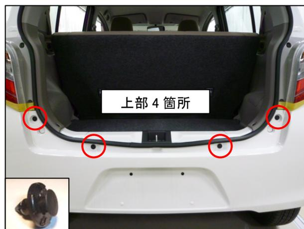
③ クリップリムーバを使用し、左右 6 箇所(片側 3 箇所)、下部 2 箇所(左右 1 箇所)のクリップを取り外します。
