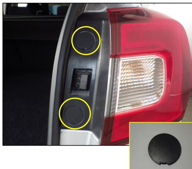
③ ボルトおよびクリップのかん合を外し、ランプ ASSY リヤコンビネーションを後方へ引き出します。
