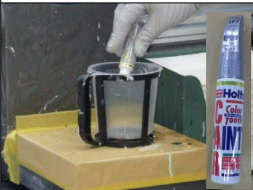
可視光パテで傷に充填し、パテを研磨します。上塗り用のマスキングを施してからPPプライマー塗布して、一液エアゾールタイプのプラサフで塗布します。今回の上塗り塗装は、市販のカラータッチペンを使用して調色は無で行いました。クリヤーは一液型ウレタンクリヤーを使用しました。
