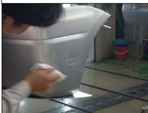
浅い擦り傷と、一部深い傷が混在している状態です。最初に清掃し傷の周りの足付けをおこないます。浅い擦り傷を研磨しフェザーエッジを作ります。
