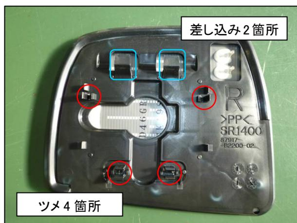
\*リヤビューミラーは、上部2箇所が下方からの差し込み方式で固定(青枠)のため、下部より取り外します。
