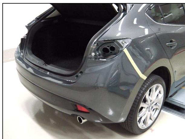
② スクリュ 3 個、ファスナおよびキャップナットを外し、リヤスプラッシュシールドを取外します。(左側同様)
