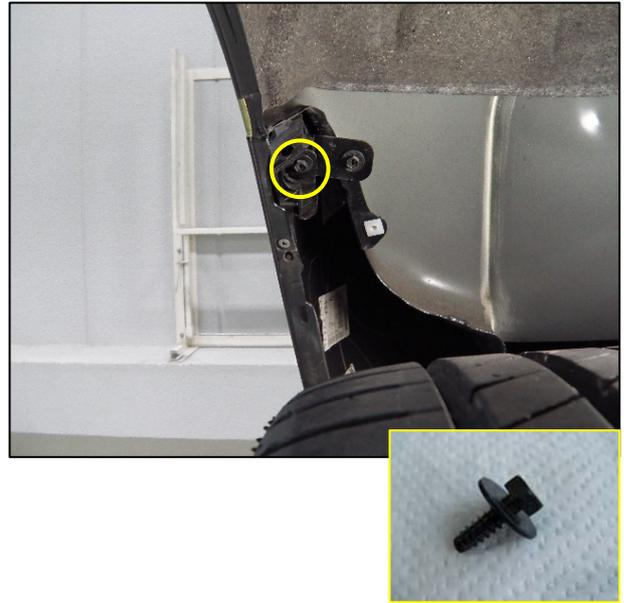
④ リヤバンパ上部のスクリュ 4 個および下部のボルト 2 本を取外します。
