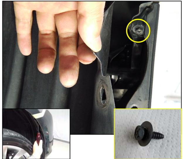
⑥ フロントアンダーカバーNo.1 のスクリユ 4 本およびファスナ 2 個を取外します。
