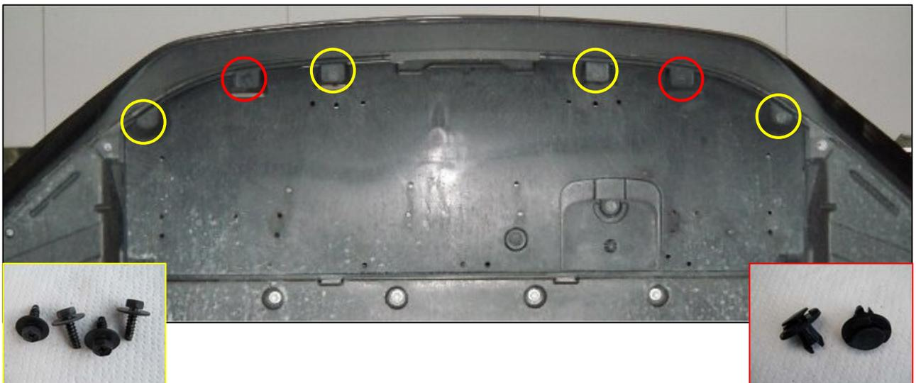
⑦ フロントアンダーカバーNo.1 をめくり、フロントバンパ下部のスクリユ 2 本およびファスナ 2 個を取外します。
