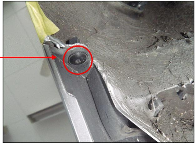
③ リヤバンパ下部、トルクスレンチを使用してクリップ 4 個を取り外します。
