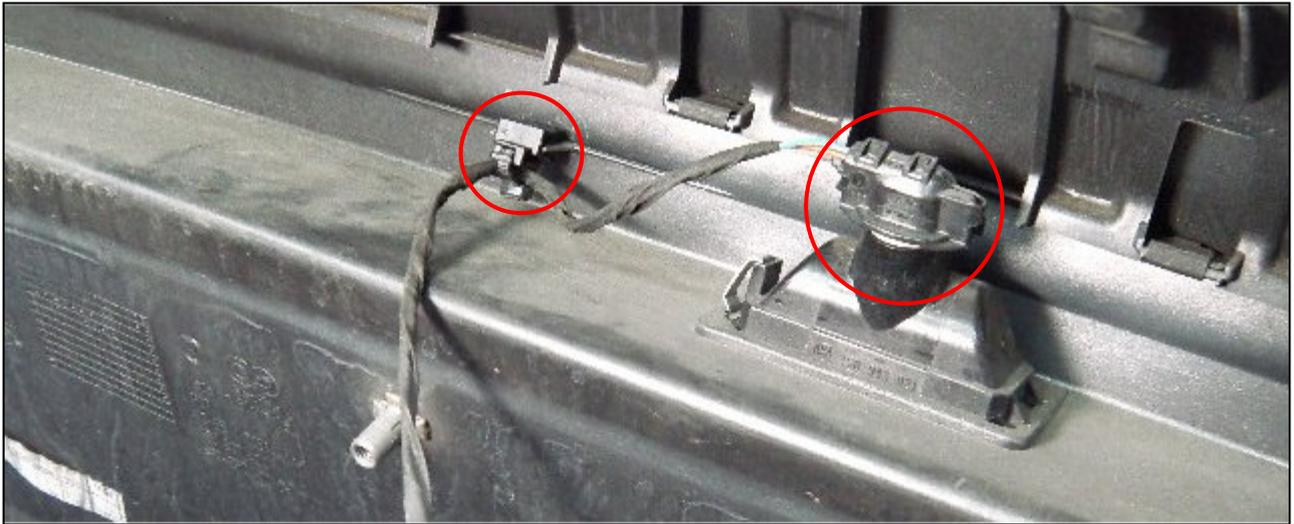
⑥ リヤバンパカバーのサイド部を手前に引き、ガイドピースのツメ勘合を外します。
