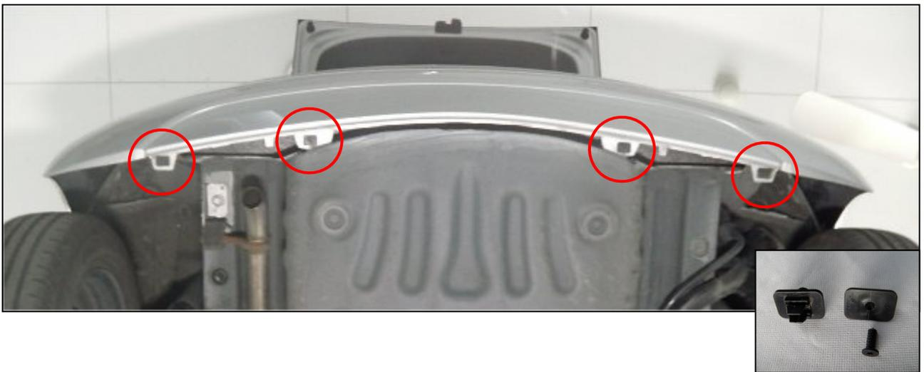
④ リヤバンパ上部、トルクスレンチを使用してスクリユ 4 本を取り外します。
