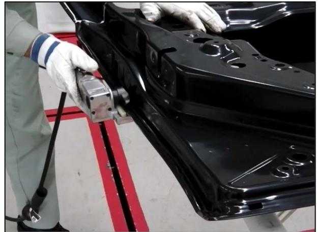
◇ 短時間でヘミング部の取外しおよび取付け作業が可能で、仕上げ面も綺麗に仕上げることが出来ました。
