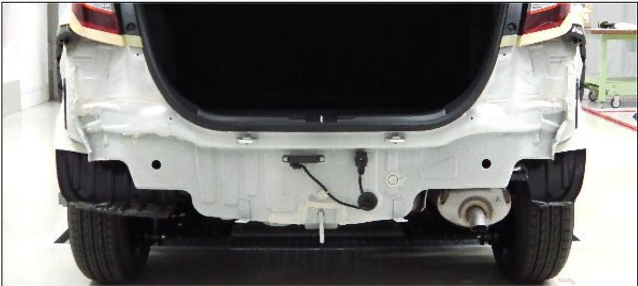
※ 使用工具：ヘキサゴンレンチ、プラスドライバ、クリップリムーバ
