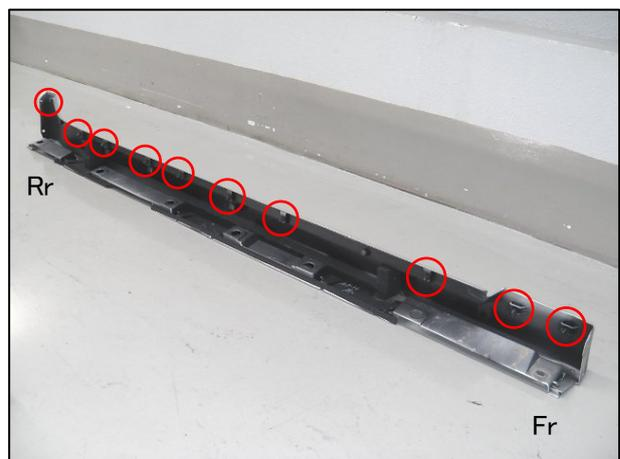
※ 使用工具: クリップリムーバ、10 ボックスレンチ、プラスドライバー
