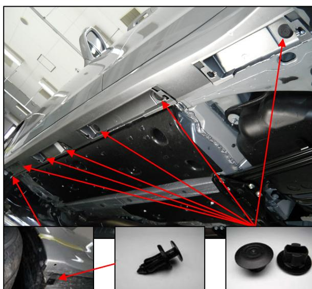
④ フロント部とリヤ部のスクリュ 2 個およびスクリュグロメットを取り外します。
