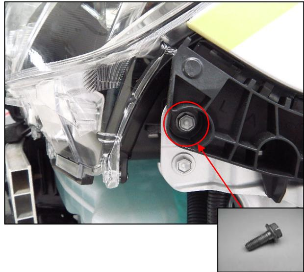
④ 各コネクタを切り離し、ヘッドランプ ASSY を取り外します。
