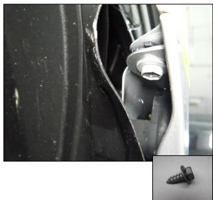
④ 上部のクリップ2個およびボルト3本を取り外します。
