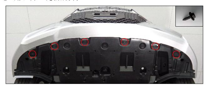
③ サイド部のピンホールドクリップ 2 個およびスクリュを取り外します。(左右) (ピンホールドクリップはマイナスドライバを使用して 90°回し取り外します)
