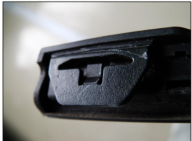
④ リムーバツールを使用して、フロントドアアウトサイドモールディング後側のツメのかん合を外します。
