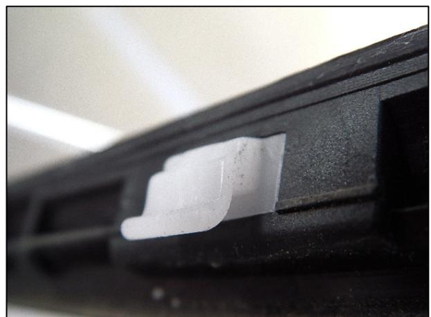
⑤ フロントドアアウトサイドモールディングを、車両外側方向にねじり、ドアパネルとのかん合を外しながらフロントドアアウトサイドモールディング取り外します。
