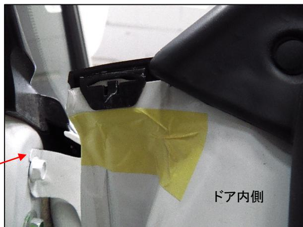
③ リムーバツールを使用して、フロントドアアウトサイドモールディング前側のツメのかん合を外します。
