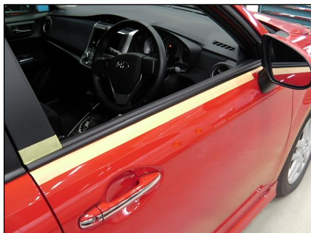
③ ベルトモールディングを下方へ押し付けながら回転させツメのかん合 6箇所を外します。
