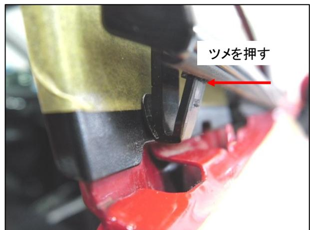
⑤ 前部はフロントドアフロントロウフレームカバーUPRに差し込まれていますので、ベルトモールディングを後方へ引き取外します。
