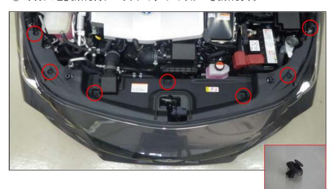
③ マイナスドライバを使用してピンホールドクリップを 90°回し、ピンホールドクリップ 2 個を取り外します。 (左右)
