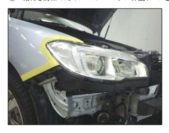
② ボルト4個およびクリップ1個を外し、ブラケット フロントバンパーコーナーを外します。
