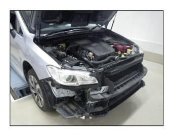
2. クリップ2個を外し、エアインテークダクトを取り外します。(右側のヘッドランプを取り外す場合)
