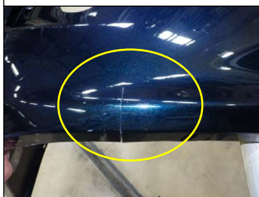
裂傷部状態(バンパー表面)
