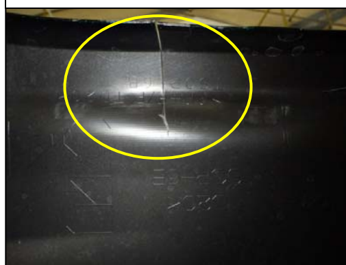
裂傷部状態(バンパー裏面)
